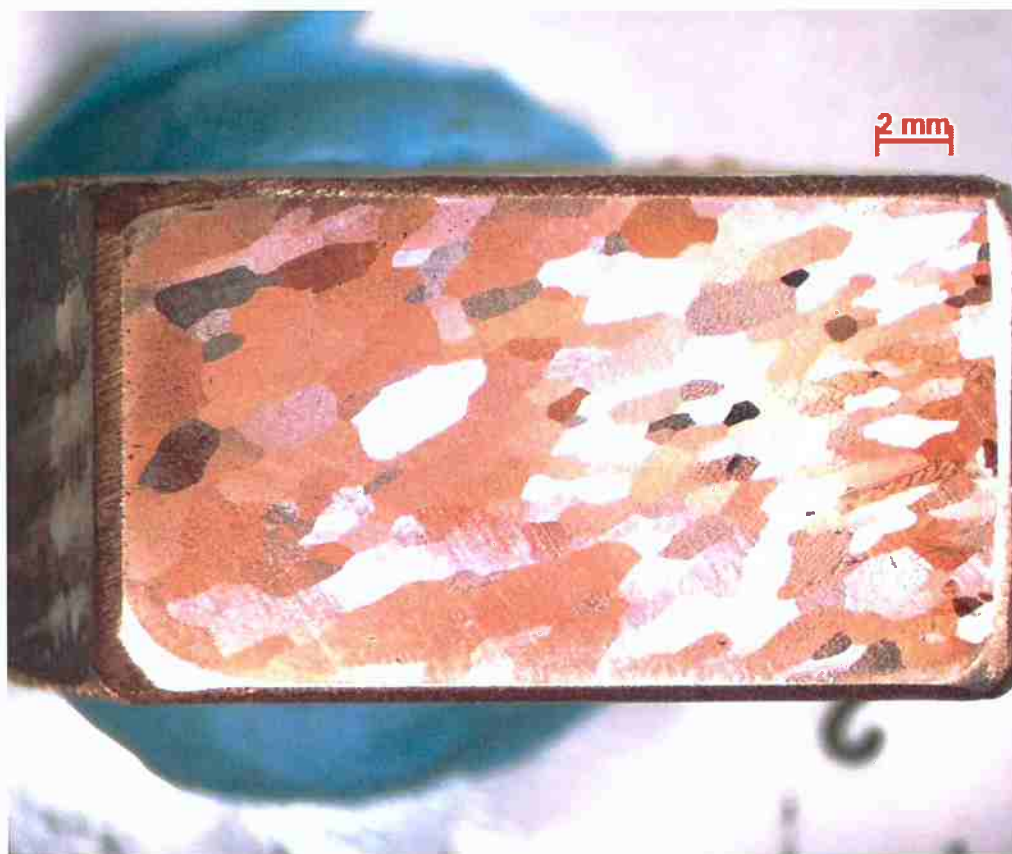
Figura 43: Macrografia da amostra TFL, 1,6x de aumento em lupa estereoscópica.
