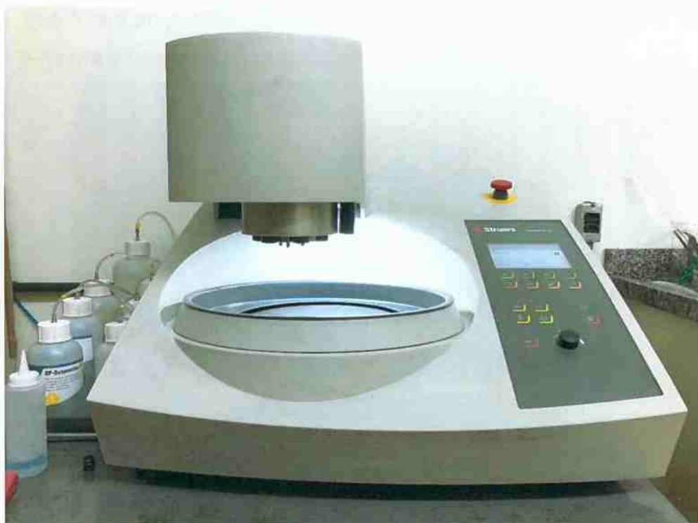
Figura 36: Politriz automática STRUERS Tegramin-25.
