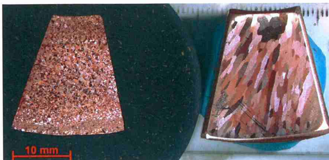
Figura 44: Comparativo entre tarugos extrudado (esq.) e fundido (dir.) no plano transversal, 1,6x de aumento em lupa estereoscópica.
