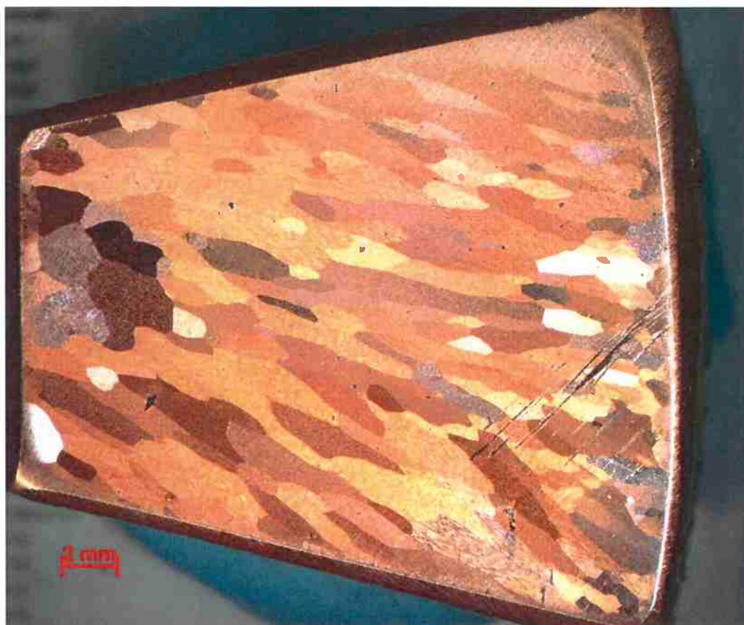
Figura 41: Macrografia da amostra TFT, 1,6x de aumento em lupa estereoscópica.
